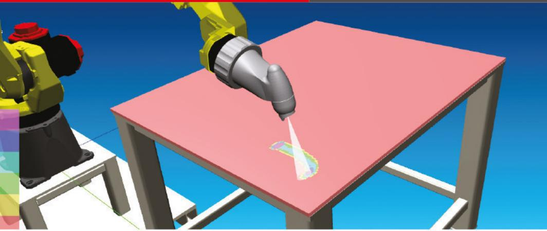
Das Ziel der Spraysimulation ist die Visualisierung des Materialauftrages. Ist das Lackierergebnis nicht befriedigend, können direkt in Eureka zusätzliche Bahnen eingefügt oder auch wieder gelöscht werden.
